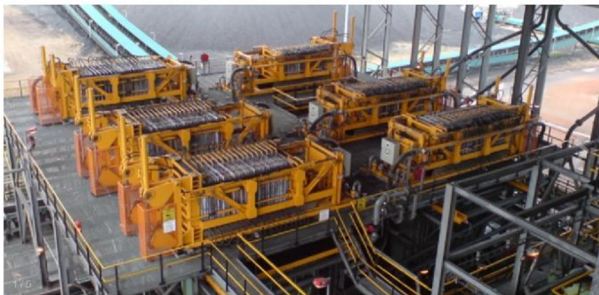
Fig. 55 – Batteria di filtropresse per la disidratazione dei fanghi
